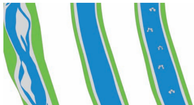
Ricalibrato di un alveo di un corso d’acqua montano e successiva posa di gruppi di massi per la creazione di habitat
