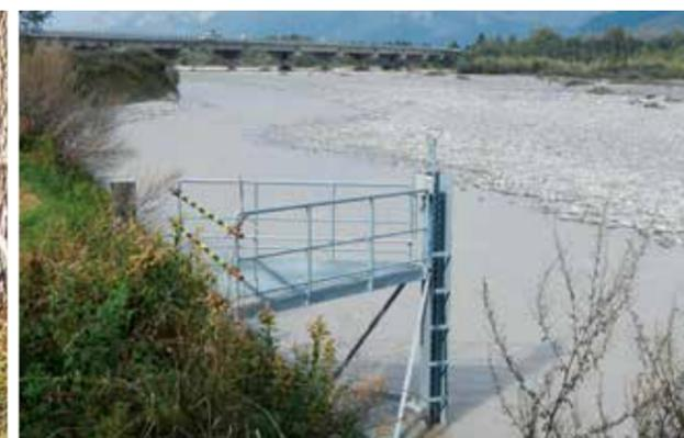
*Sonde per la misurazione dei solidi sospesi totali e dell'ossigeno disciolto, posizionate lungo il torrente Ambiesta e il fiume Tagliamento.*
