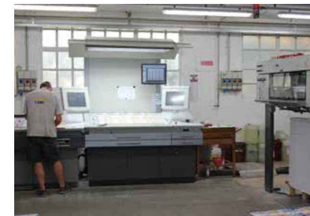
La postazione di controllo dalla quale si verifica la qualità della stampa.
